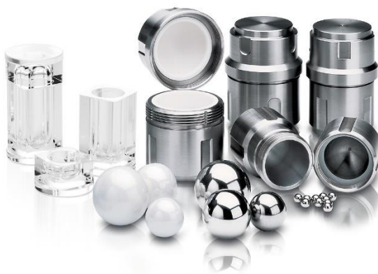
15. ábra Retsch Mixing Mill MM 400 típusú keverőmalomban használható reakcióedények és őrlőgolyók, középen az általunk használt \text{ZrO}_2 bélésű edény és golyók
