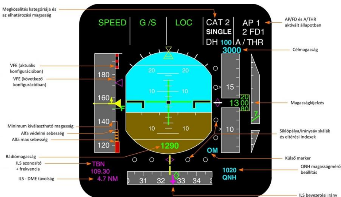
5. ábra Az A320-as típuscsalád EADI kijelzője emelkedés közben [8] Szerkesztette: Solymossi László
