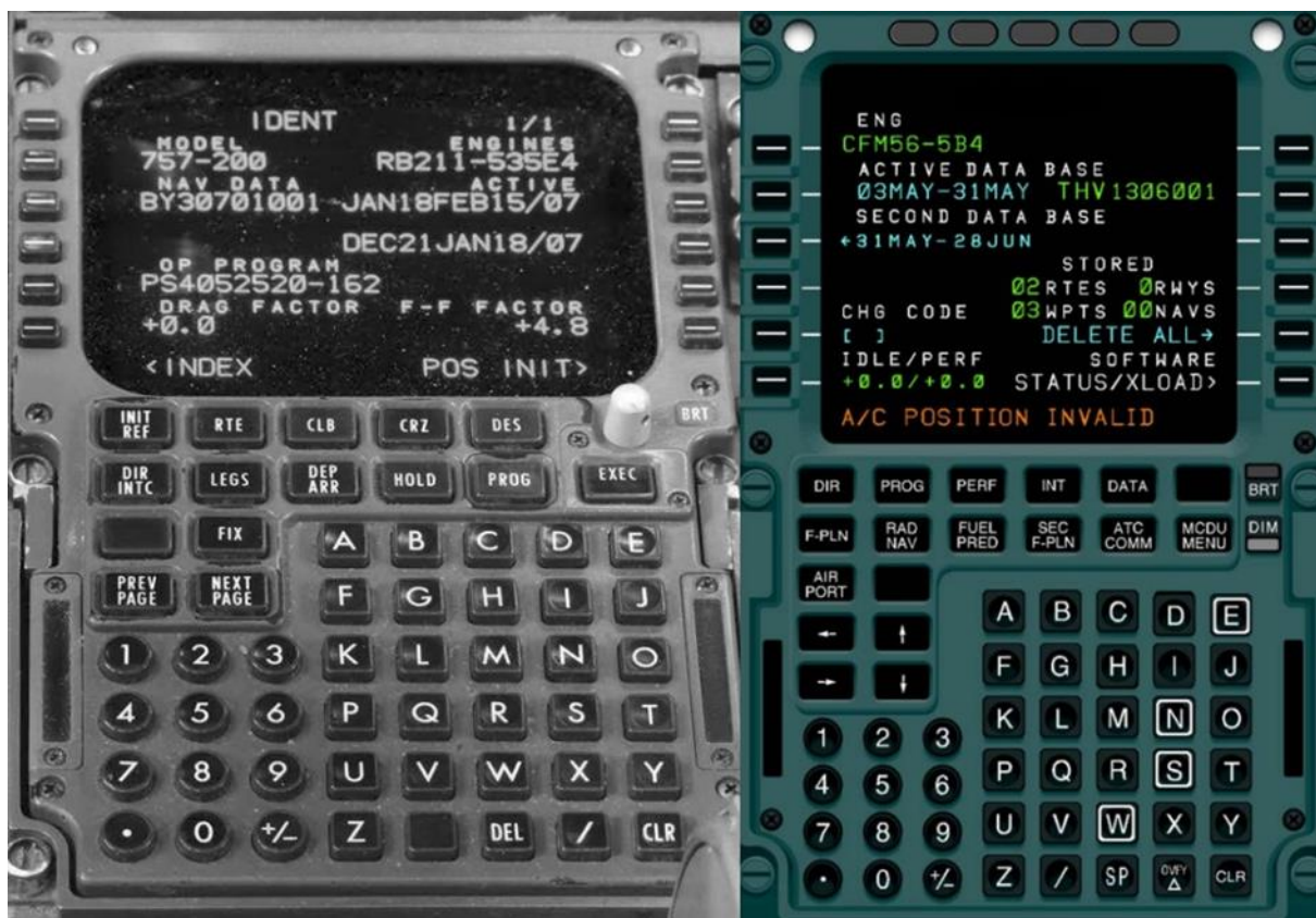
42. ábra Boeing (bal) és Airbus (jobb) típusú CDU [22], [23] Szerkesztette: Solymossi László
