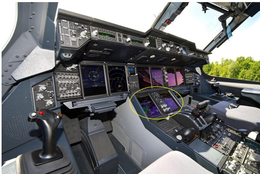
40. ábra Az A400M katonai szállítórepülőgép korszerű FMS (MFD) kijelzői (felettük láthatóak az ECAM és EFIS rendszer kijelzői, szintén MFD kijelző felületen) [24] Szerkesztette: Solymossi László
