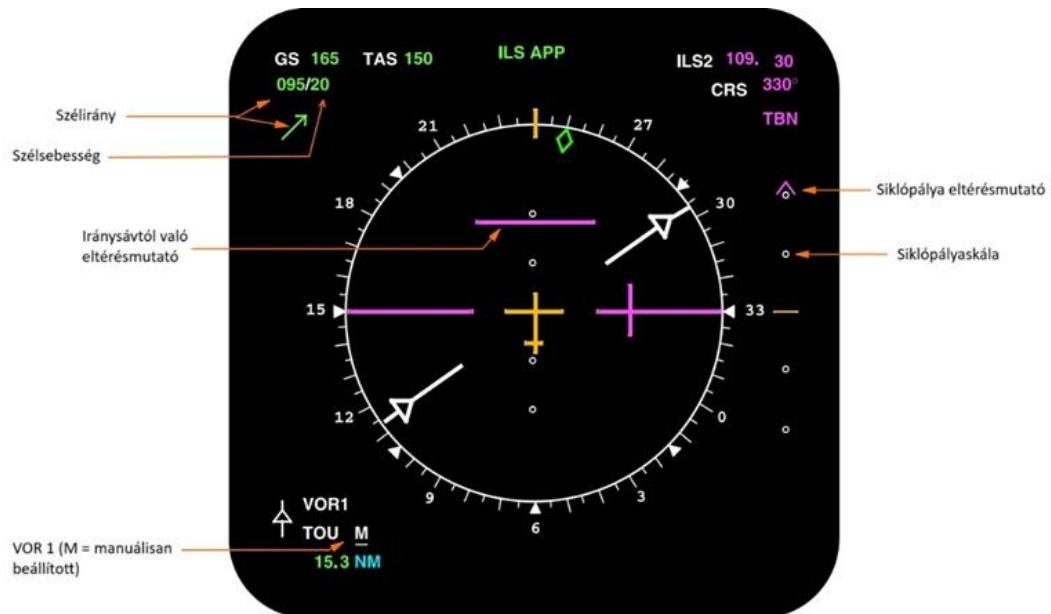
11. ábra Az A320-as típuscsalád ND kijelzőjének ILS módja [8] Szerkesztette: Solymossi László
