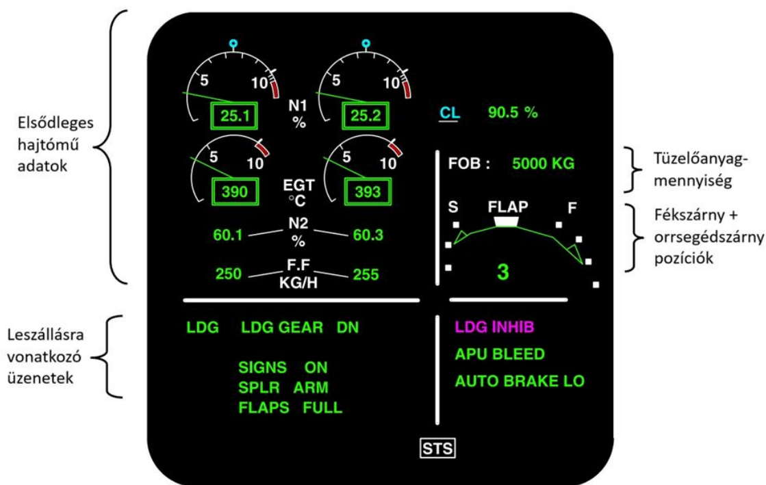
25. ábra Az A320-as típuscsalád ECAM rendszerének felső kijelzője NORMAL módban, leszállás közben [8] Szerkesztette: Solymossi László
