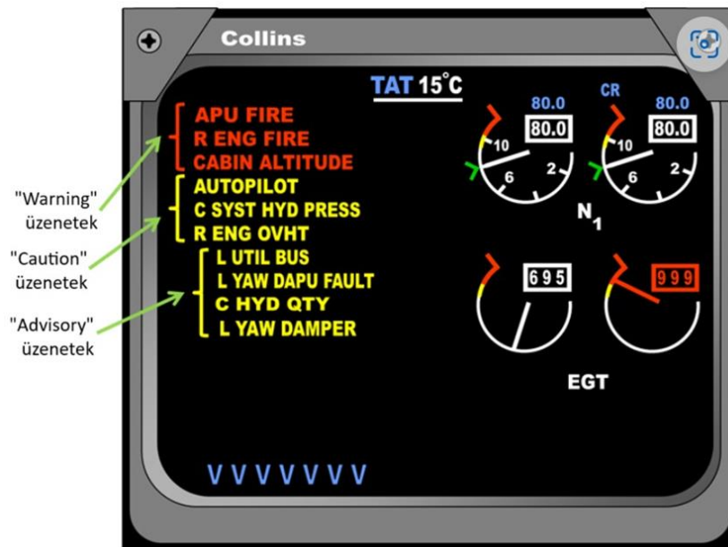
15. ábra Az elsődleges EICAS kijelző összetettebb figyelmeztető üzenetekkel [16] Szerkesztette: Solymossi László
