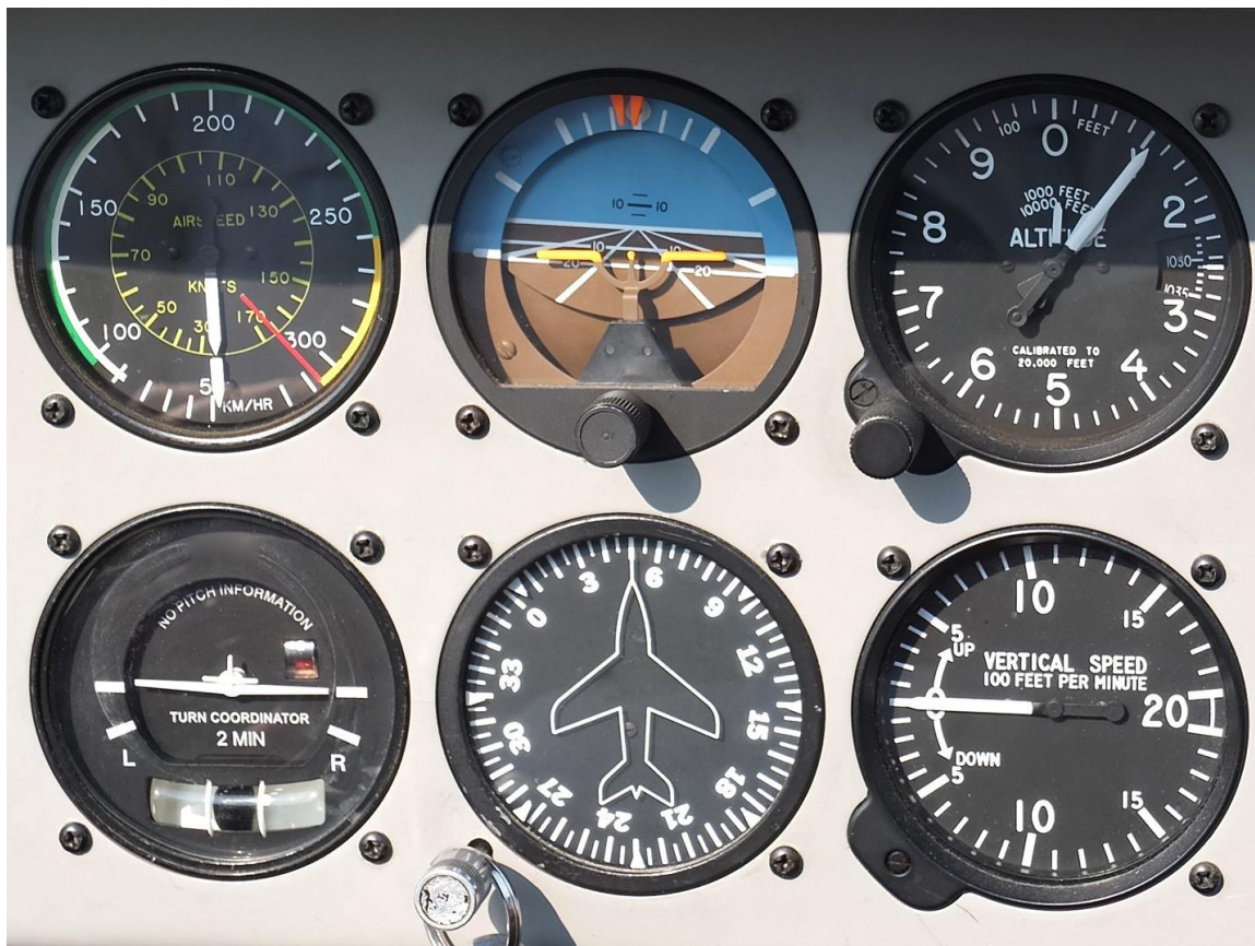
1. ábra Hatos elrendezés („6 pack”) [9] Szerkesztette: Solymossi László
