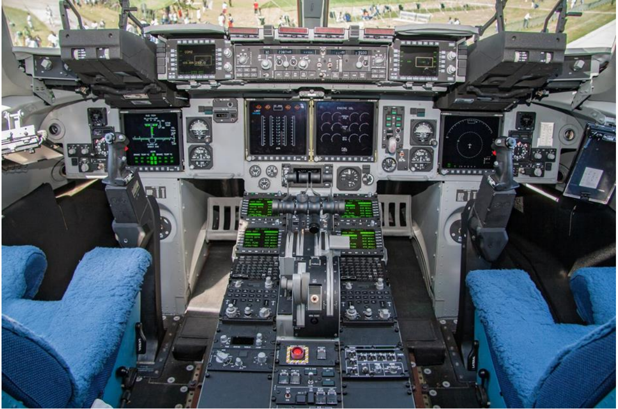
13. ábra A SAC 54 program keretében Pápán állomásozó, F-207 SAC-01 oldalszámú C-17-es katonai szállítórepülőgép és négy MFD kijelzője. Képet készítette: Martényi Tamás (Pápa, 2009.)
