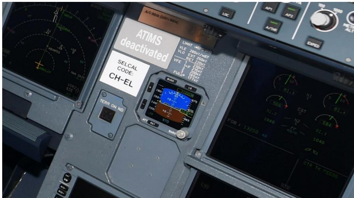
46. ábra Az A319-es típus integrált tartalék műszerrendszere Képet készítette: Józsa Dávid (2019)
