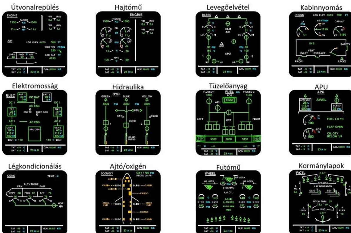
29. ábra Az A320-as típuscsalád ECAM rendszerének alsó kijelzőjén manuálisan kiválasztható 12 rendszer oldala [8] Szerkesztette: Solymossi László
