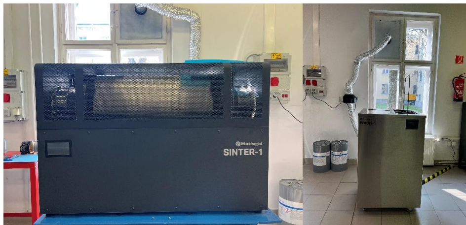
7. Kép Markforged MetalX 3D nyomtatóhoz tartozó kemence és mosó 32
