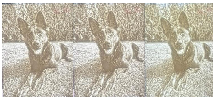
14. kép 60 mm/s, 40 mm/s illetve 20 mm/s nyomtatási sebességgel készült litofán képek 49
