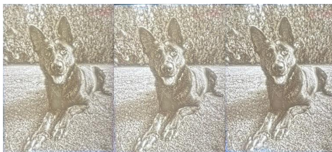
13. kép 120 mm/s, 100 mm/s illetve 80 mm/s nyomtatási sebességgel készült litofán képek 48
