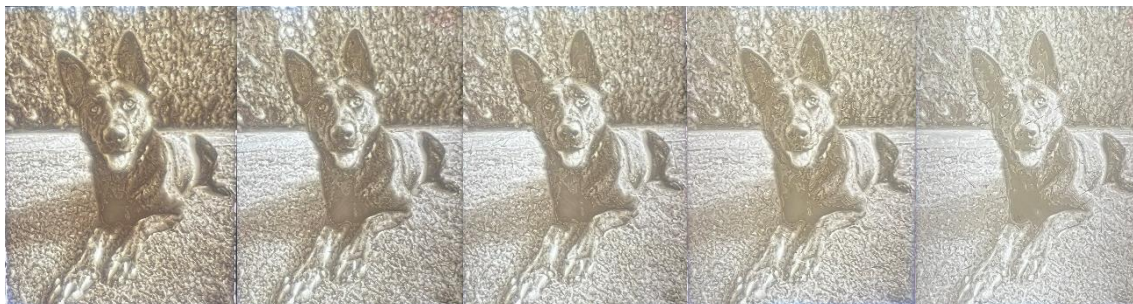
12. kép Különböző maximális vastagsággal elkészített litofán képek átvilágítva (4 mm, 3,5 mm, 3 mm, 2,5 mm, 2 mm) 47
