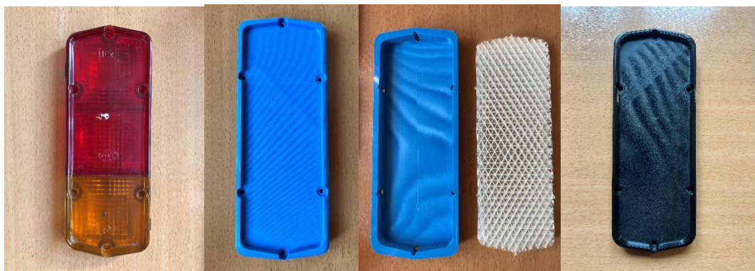
20. kép Az eredeti lámpabúra és annak nyomtatott változatai 55
