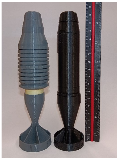
31. ábra 3D nyomtatott VOG-25P (balra) és VOG-17 (jobbra) imitációra szerelt stabilizátor szárnyak Forrás: A szerző felvétele.
