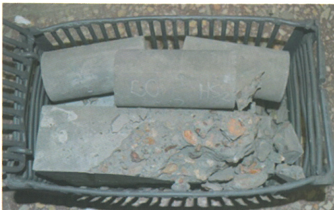
4. ábra: 1000°C hőterhelést követően az épen maradt henger alakú próbatestek, illetve a tönkrement hasáb alakú próbatestek
