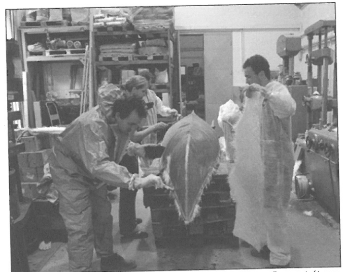
2. ábra: A hajótest szaluzatának kialakítás üvegszálal műanyagból egy tényleges versenyhajó felhasználásával
