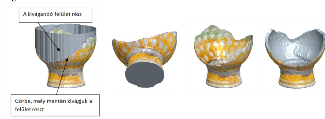
6. ábra a) Felesleges rész kivágása; b) Alsó felület; c) Kész felület modell; d) Test modell
