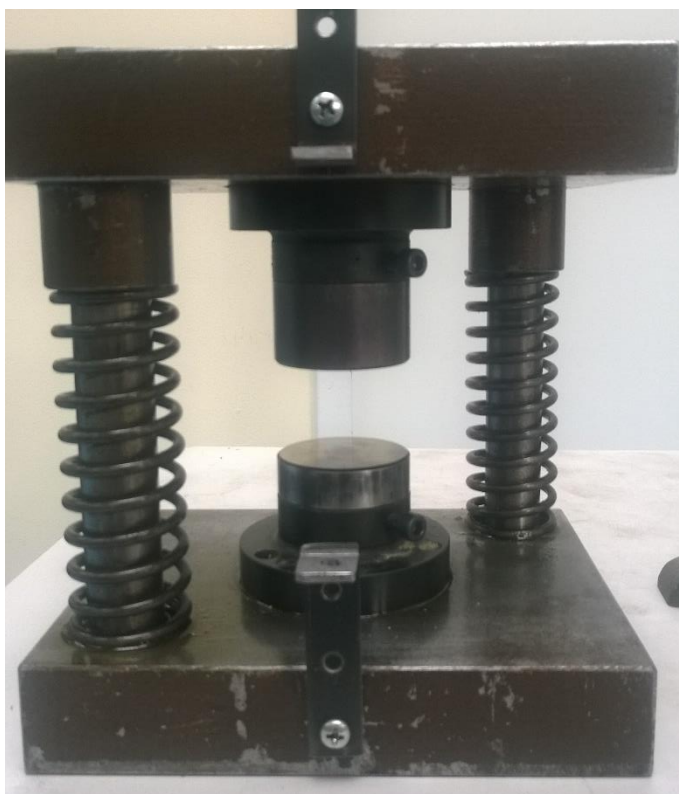
5.2. ábra A zömítő vizsgálatokhoz használt kétoszlopos zömítő szerszám
