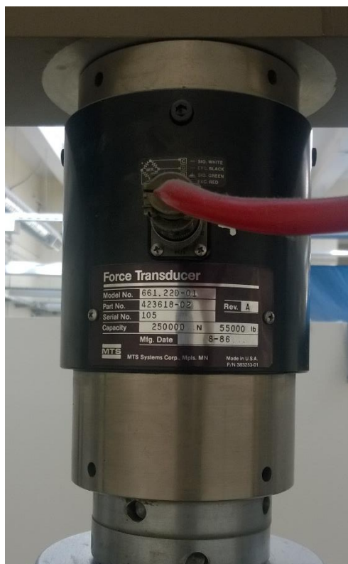
5.1. ábra Az MTS 810 típusú hidraulikus, univerzális anyagvizsgáló 250 kN-os erőmérő cellája
