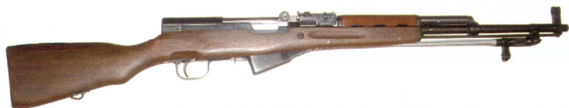
A szovjet SzKSz öntöltő karabély a Magyarországon mai napig rendszerben levő 7,62x39 mm-es lőszert tüzeli
