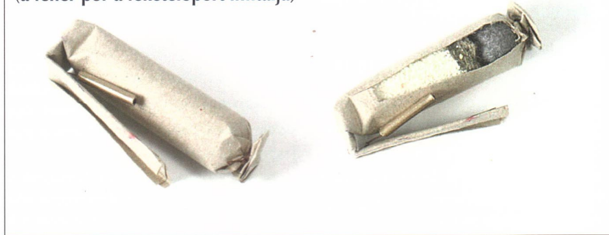
Az 1844 mintájú Augustin töltény és metszete (a fehér por a feketelőport imitálja)
