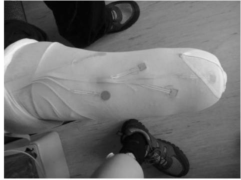
4. ábra. A hat érzékelő helye a végtagcsonkon (az ábrán ötnek a helyzete látható, míg a hatodik hátul helyezkedik el)
