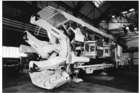
4. ábra. Többitárcsás karokkal ellátott alagút-fűrő gép. Kör alakú változtatható átmérőjű vágatok előhajtására alkalmas
