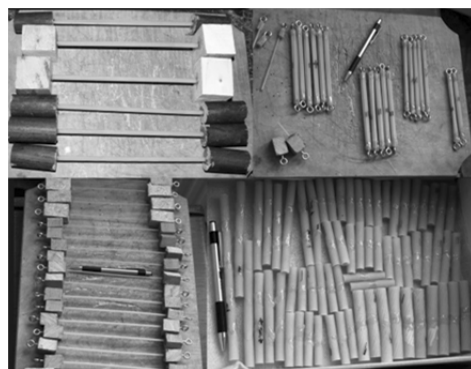
5. ábra. Próbatestek készítése az anyagjellemzők megállapításához [8]
