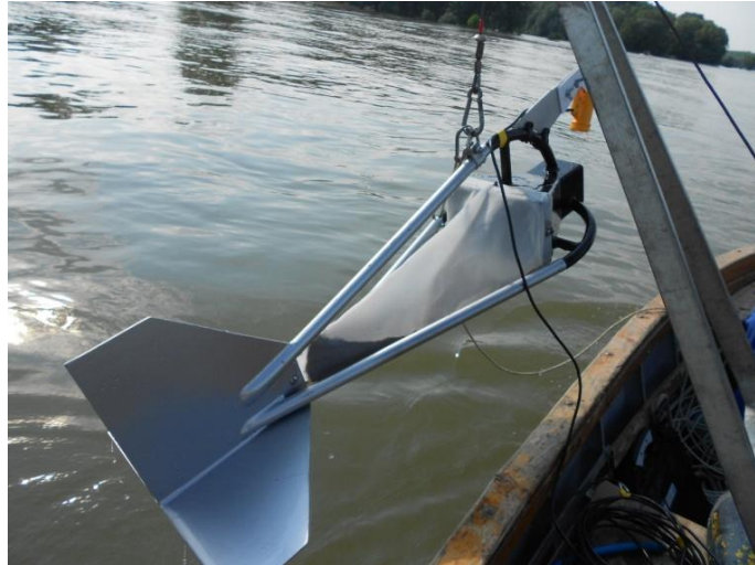
3. fotó. Helley-Smith görgetett hordalék mintavevő
