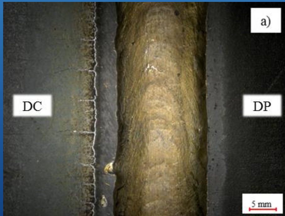
DP-DC acélpárosítások keményforrasztása: a) DP-DC koronája, b) DP-DC gyök oldala
