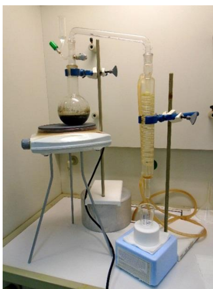
2. ábra Illósav meghatározása desztillálással
