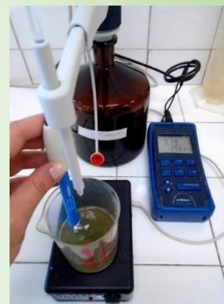
3. ábra Lúgosság meghatározása folyamatos pH mérés mellett
