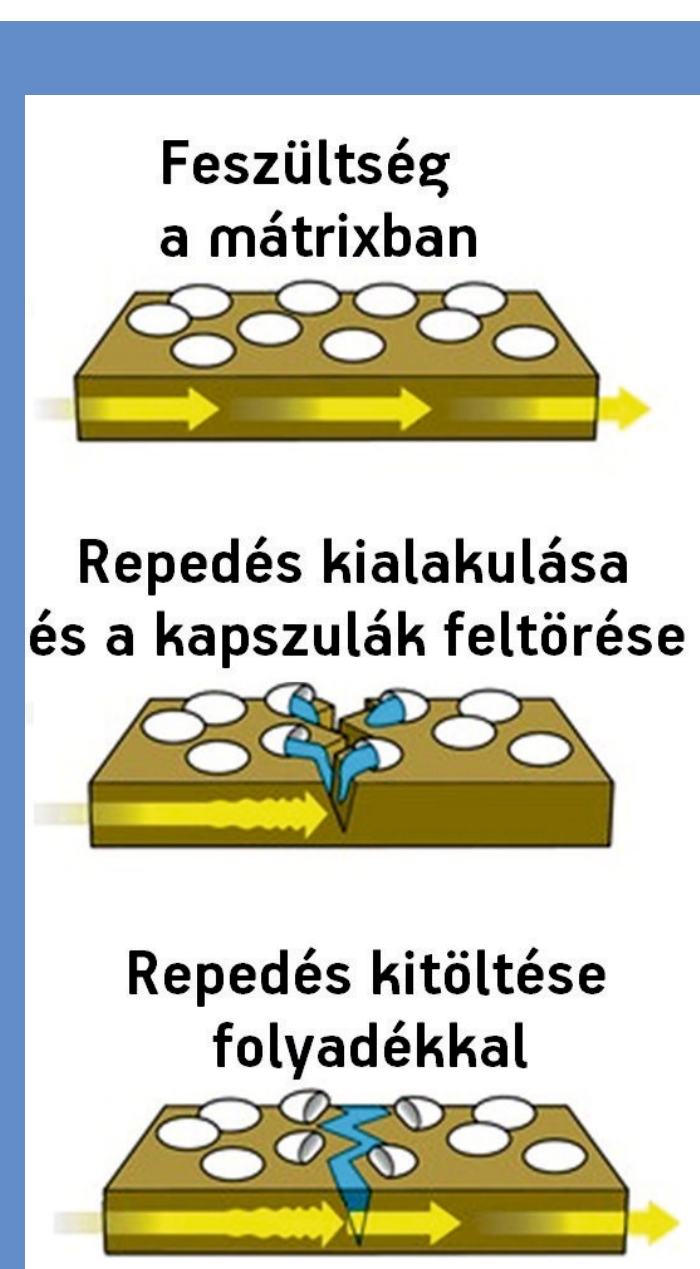
1. ábra | Mikrokapszulák működési mechanizmusa
