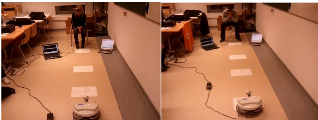
43. ábra. Mobil robot agyhullám alapú mobil irányításának tesztelése. Forrás: Saját készítésű fotó
