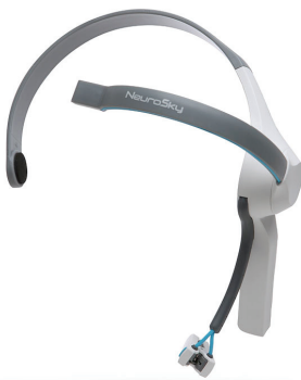
4. ábra. MindWave mobil EEG-érzékelő és jelfeldolgozó egység.
