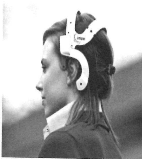
4. ábra. IMEC és a Holst Centre által fejlesztett EEG-headset (2011).
