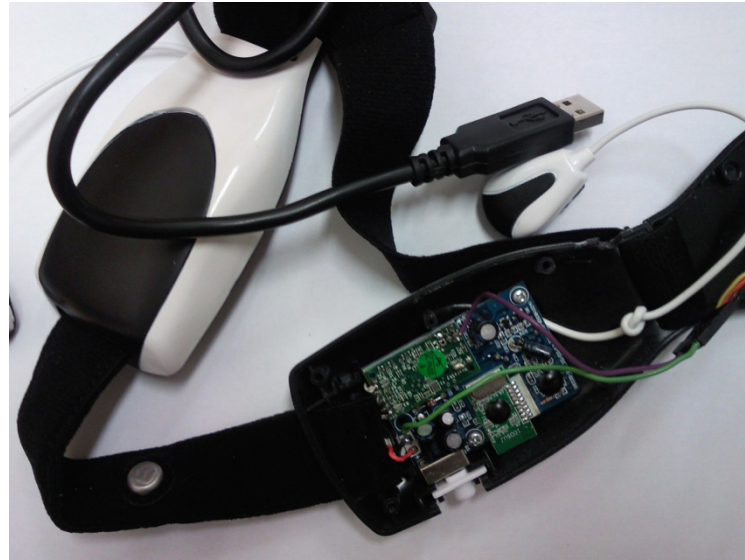
4. ábra: USB – UART-átalakító MindFlex headset-tel történő összekötése.
