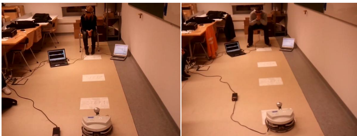
45. ábra. Agyhullám alapú mobil robot irányításának tesztelése.
