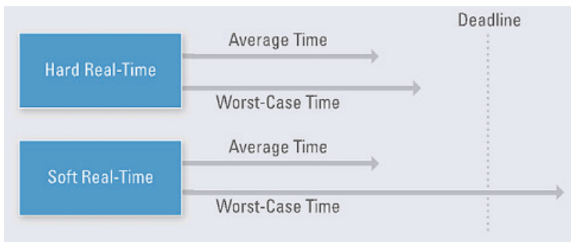
1. ábra. Hard és Soft Real-Time alkalmazások időzítése (Deadline: feldolgozási határidő). [9]
