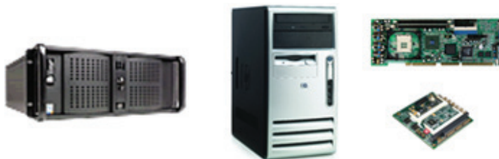
8. ábra. Ipari számítógép, asztali számítógép, Single-Board számítógép (SBC) vagy egyéb PC-104 processzor-kártya mint valósídejű hardver.
