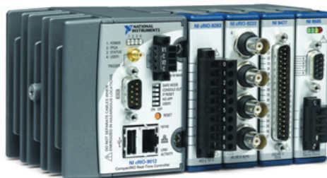
5. ábra. CompactRIO nyújt valós idejű alkalmazásokhoz.
