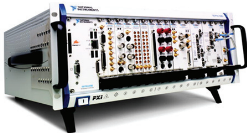
3. ábra. Masszív házba helyezett PXI-hardver ipari környezetben történő alkalmazáshoz, valós idejű programok futtatásához.
