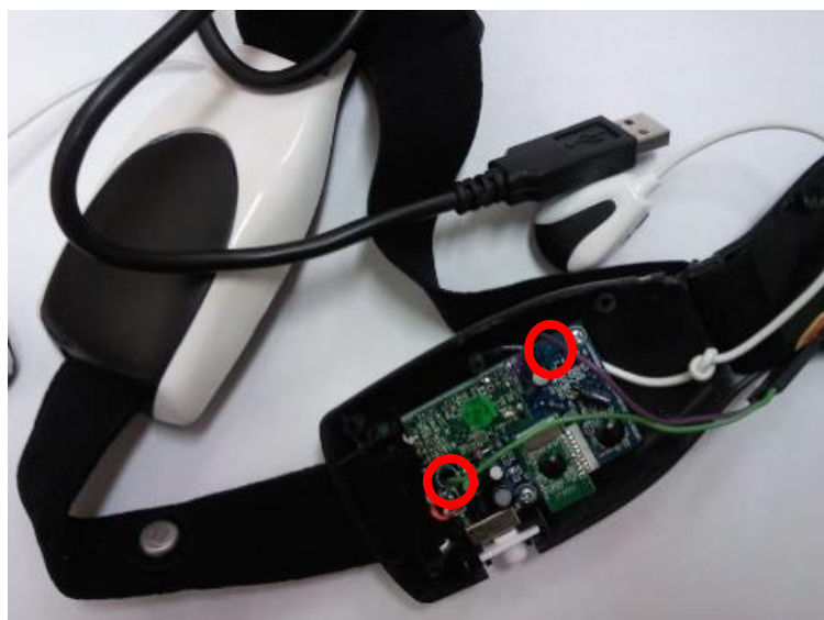
15. ábra: USB UART átalakító MindFlex EEG headset-tel történő összekötése
