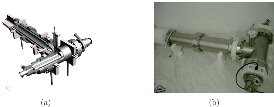
1. ábra. 3-elektrodás lágy-röntgen lézer tervezési (a) és kiviteli (b) fázisban.
