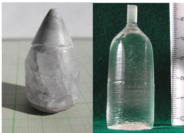
1. ábra: Bridgman (bal) és Czochralski (jobb) módszerrel növesztett adalékolatlan LYB kristályok.
