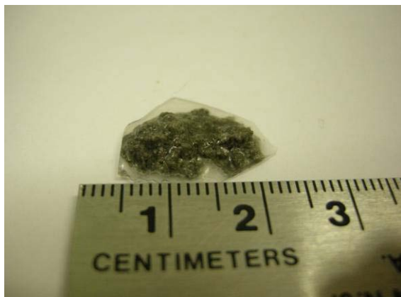
9. ábra. A salakból származó S1 minta makroszkópos képe.
