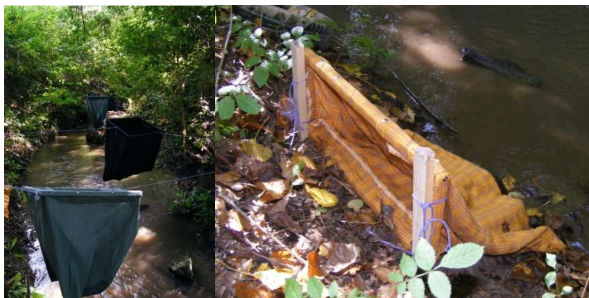
1. ábra Vertikális (fall-in) (a) és a laterális (blow-in) (b) avarcsapdák
