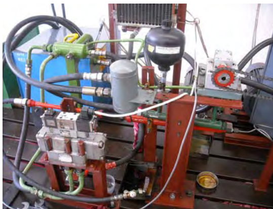
Obr. 6 Membránový akumulátor v hydraulickom obvode Fig. 6 Diaphragm accumulator in the hydraulic circuit
