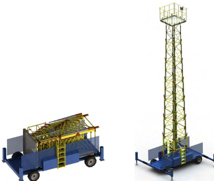
a) zložené zdvíhacie zariadenie b) rozložené zdvíhacie zariadenie
