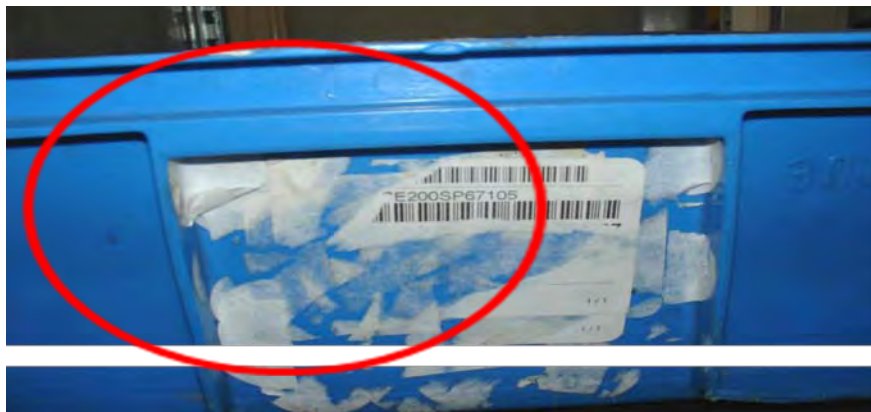
Obr.1 Poškodený identifikačný štítok.
