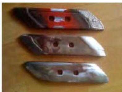
Obr. 8 Skenované lemeše – s návarom, mierne opotrebený, silne opotrebený Fig. 8 Scanned harrow spades – with weld deposit, slightly worn, heavy worn
