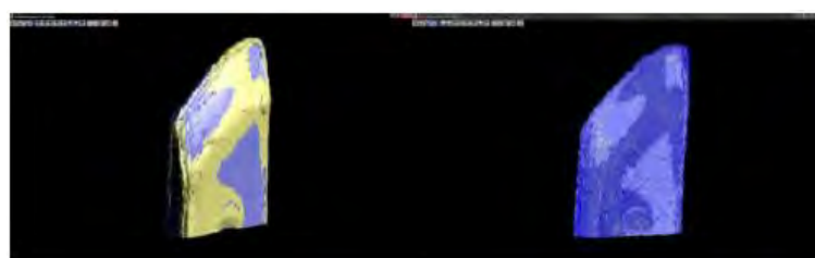
Obr. 10 Zobrazenie opotrebenia „lemeš s návarom – lemeš opotrebený“ Na ľavom obrázku – farebné prevedenie (opotrebenie zobrazené žltou farbou) Na pravom obrázku – sieťová štruktúra (opotrebenie zobrazené tmavou farbou)
