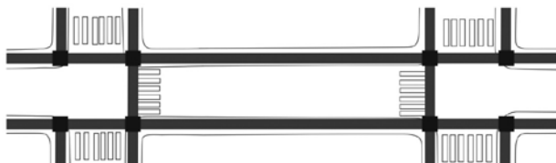
3. ábra - Levezetett gyalogos gráf az előző példa útszakaszára. Az átkelők nélkül szigetek keletkeznek.
