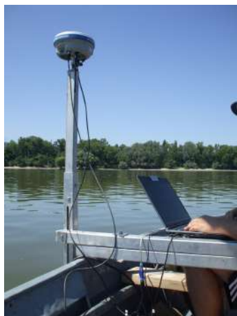
3.2. ábra: ADCP-hez kapcsolt GPS jel-vevő és az adatfeldolgozó számítógép
