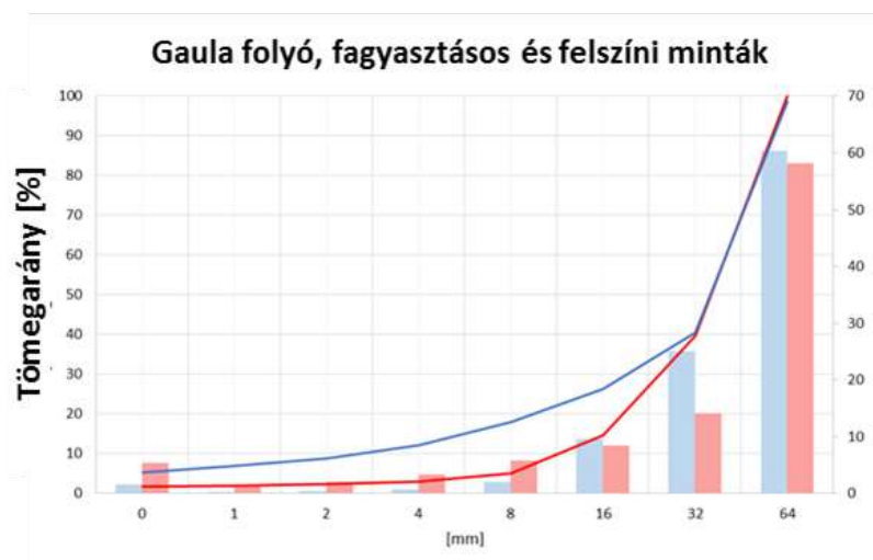
7.15. ábra: FP 1 (fagyasztásos) és a BP 1 (felszíni) jelű minta szemösszetéti és szemeloszlási görbéje. A kék görbe és diagramok a fagyasztásos (FP 1), a piros görbe és diagramok a felszíni mederanyag (BP 1 ) mintához tartoznak
