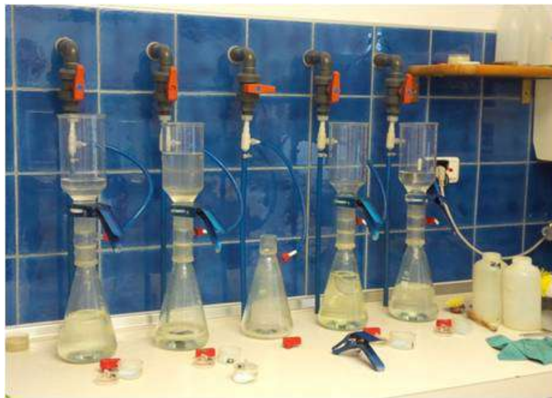
8.3. ábra: Minták szűrése a Via Donau Aschach-i laborjában (Heimann et al., 2013)
