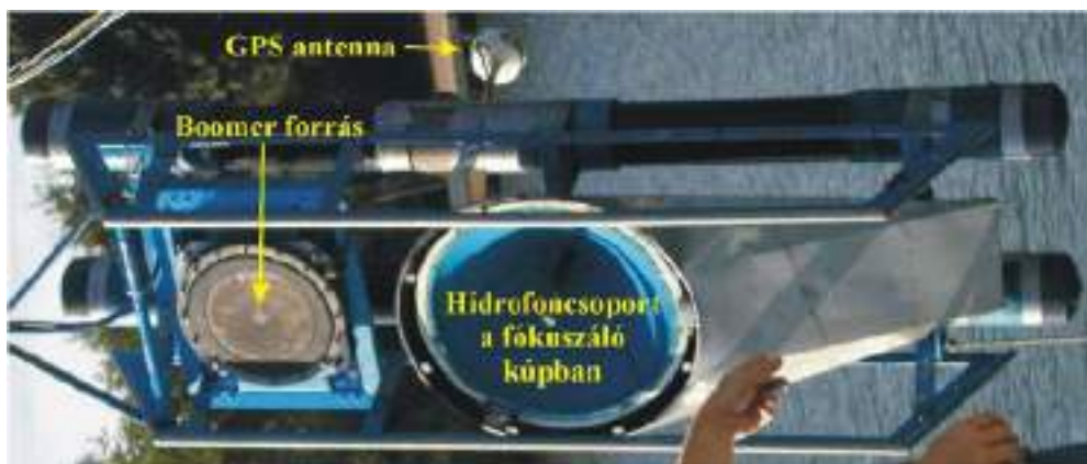
9.4. ábra: Az IKB-Seistec TM alulnézeti képe a főbb részek megnevezésével
