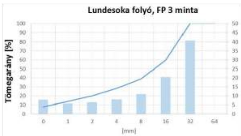
7.14. ábra: A FP 3 jelű minta szemösszetéti és szemeloszlási görbéje
