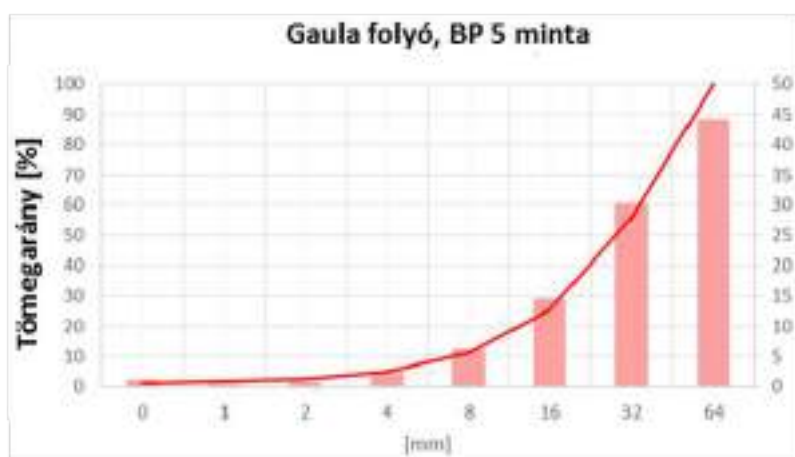
7.13. ábra: A BP 5 jelű minta szemösszetéti és szemeloszlási görbéje
