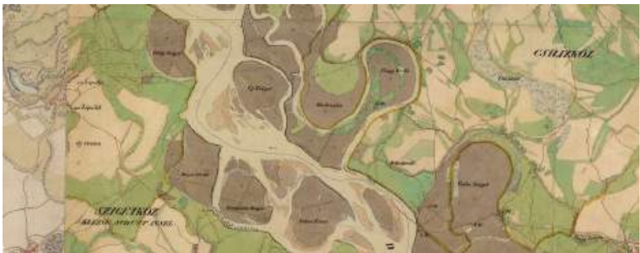
A.1. ábra: A szabályozás előtt vándorló alaktípusú Duna a szigetköz/csalókői szakaszon, a második katonai felmérés szelvényeiből képezett georeferált mozaikon. E szakaszt később töltésekkel szabályozták, majd 1993 óta a bősi (Gabčíkovo) vízlépcső alakította át teljesen a tájat.
