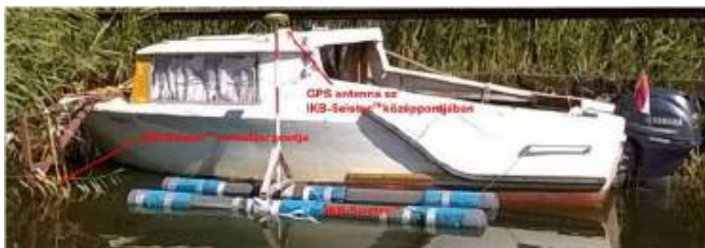
9.5. ábra: Az IKB-Seistec TM egycsatornás szeizmoakusztikus mérőműszer a mérőhajó mellett
