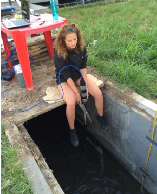
A Parshall csatorna rohanó vízmozgású, alvízi szakaszán hajtottuk végre a pontbeli sebességméréseket
