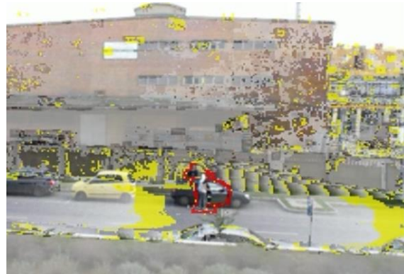
Megvilágításváltozás toleráns adaptív háttér kivonás
