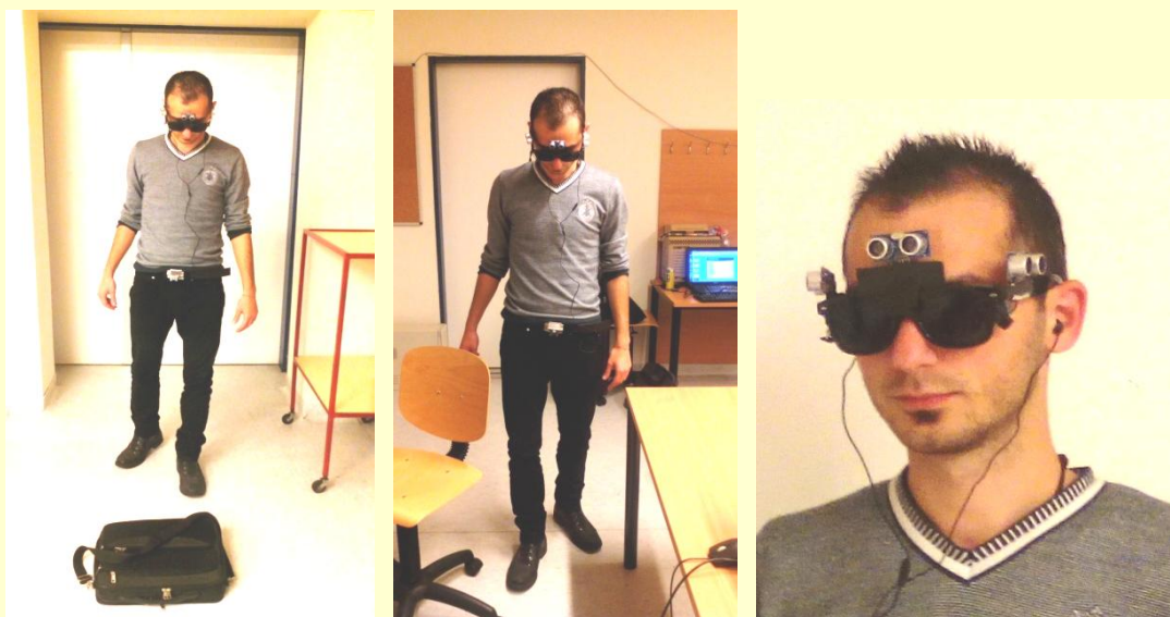
11. ábra Járás közbeni járófelület magasságváltozás detektálása
