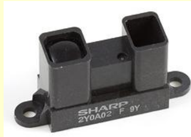
3. ábra Sharp GP2D120XJ00F típusú infravörös távolságérzékelő
