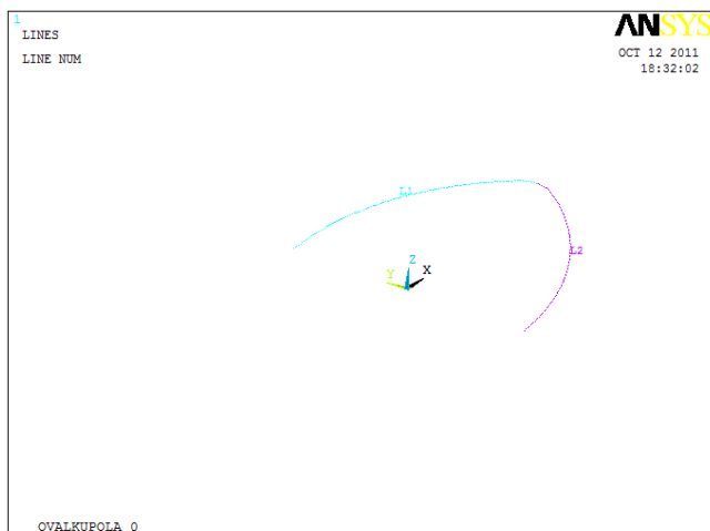
86.ábra Alaprajzi ovális görbe és a megforgatásával keletkező felület
