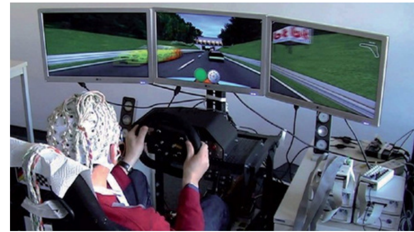
7. ábra Agyhullám érzékelésen alapuló fékezést segítő rendszer
