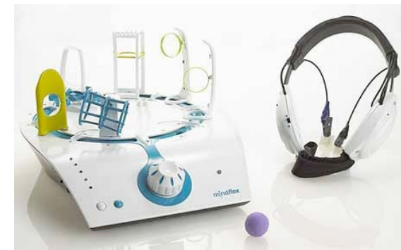
3. ábra: MindFlex EEG irányításra készített eszköze
