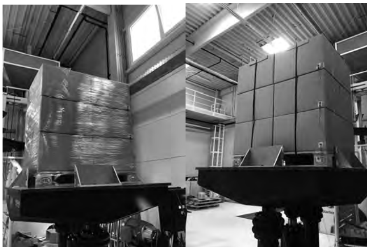
2.- 3. ábra: Nyújtható fóliás és pántolt vizsgálati minta rakomány Forrás: saját ábra
