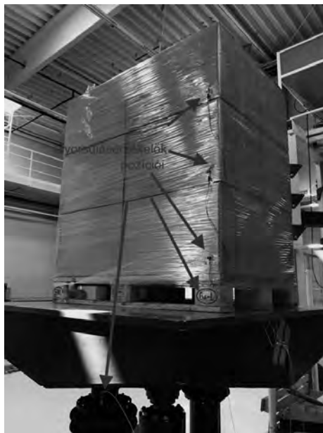
4. ábra: Gyorsulásérzékelők elhelyezkedése a mérés során Forrás: saját ábra
