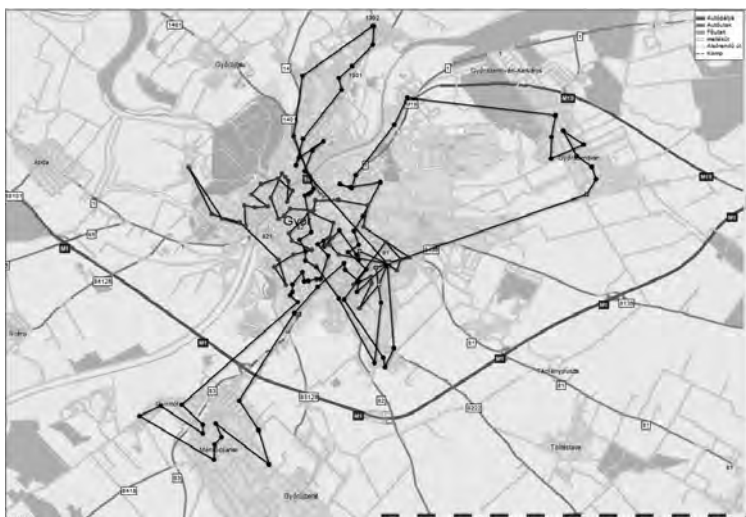
10. ábra: 3. napon történő 121 edény optimalizált begyűjtési terve 12
