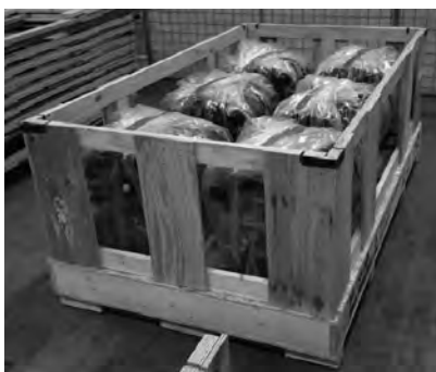
3. ábra: CKD motorok tengerentúli kiszállítására alkalmazott többutas csomagolás
