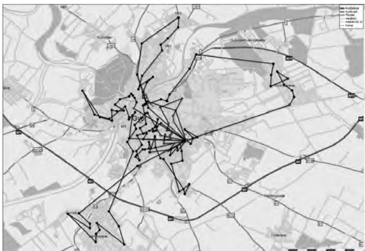
8. ábra: 1. napon történő 155 edény optimalizált begyűjtési terve 10
