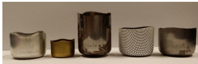
3. ÁBRA FÜLESEDÉS MEGJELENÉS MÉLYHÚZÁSNÁL (SAJÁT FELVÉTEL)
