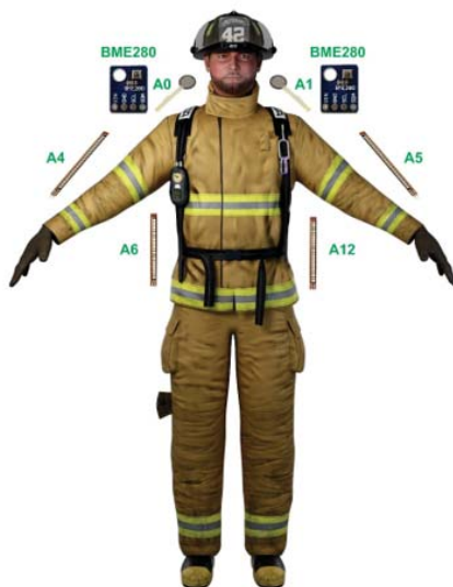
7. ábra: Személyes telemetrikus rendszer tűzoltósági felhasználásra.
