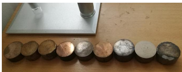
4. ábra. A teszt felületek különböző színű és foltosságú ötvözetekből. A foltosságot ebben az esetben kémiai kezeléssel mesterségesen értük el. A képen balról jobbra haladva jelölik számok a mintákat 1..9 között folytonosan.
