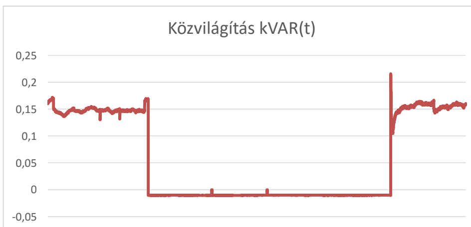
4-12. ábra: közvilágítás meddőteljesítmény felvétele (24 óra)
