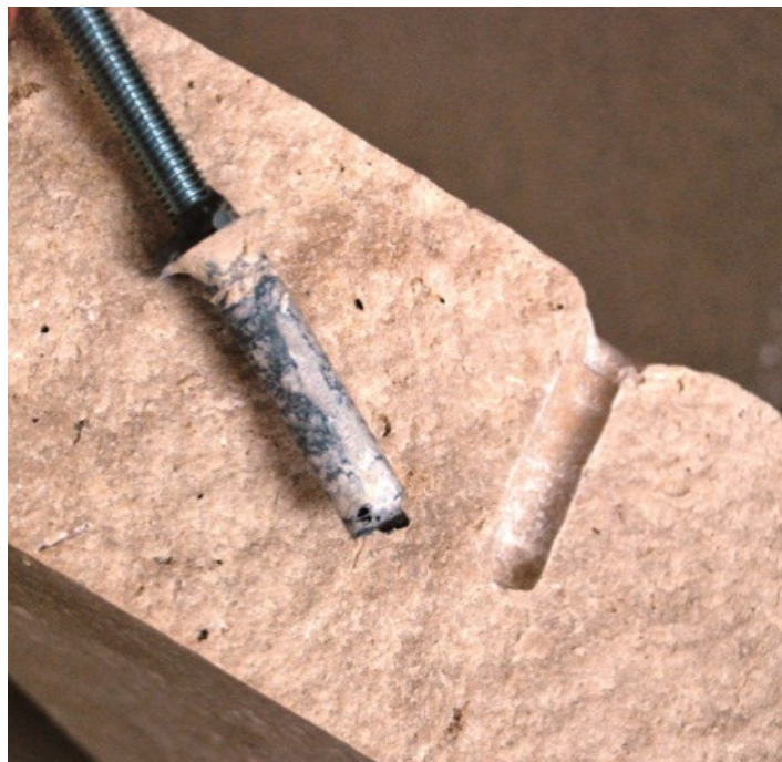
10. ábra. Tapadás megszűnése, rögzítőelem kihúzódása édesvízi mészkő próbatestből
