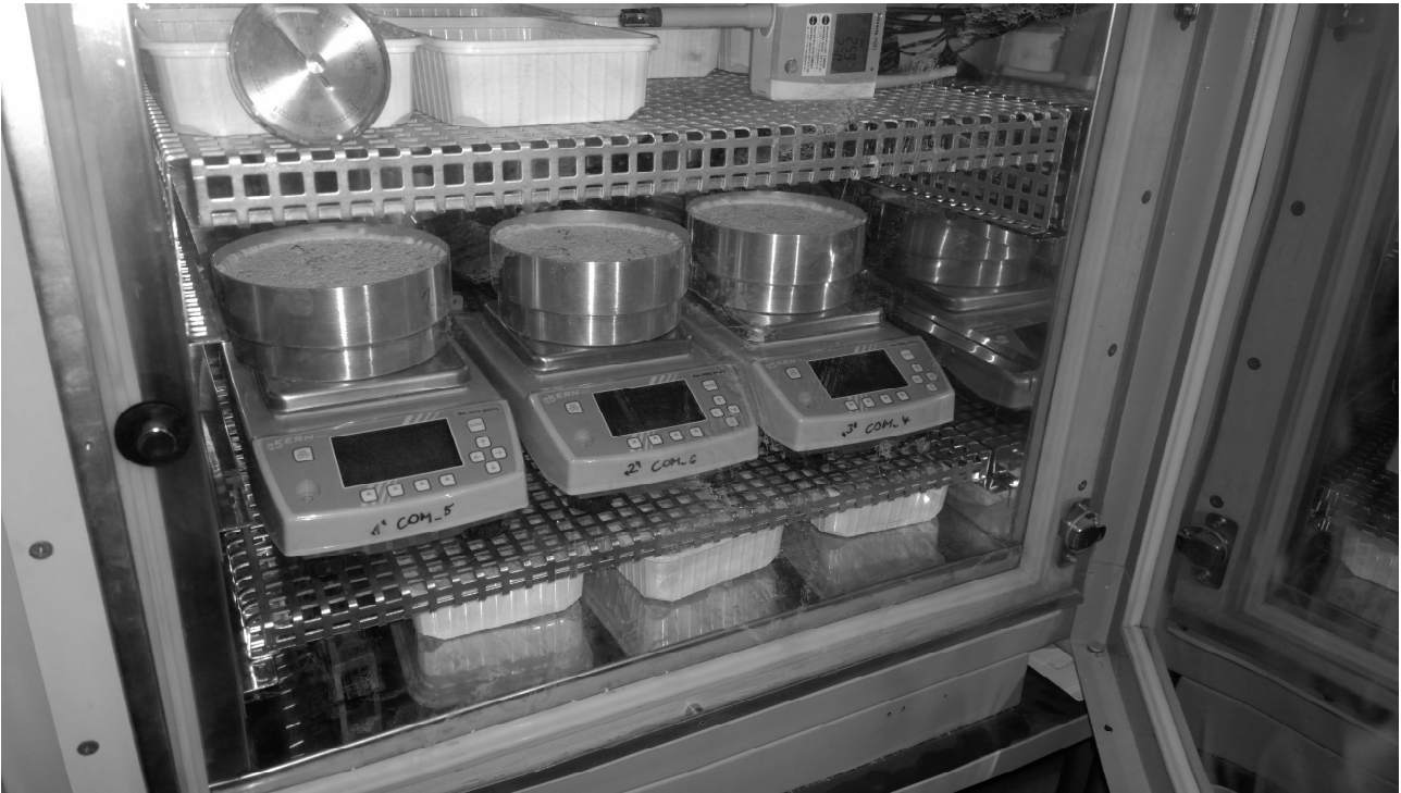
Fig. 3. Measurement of vapor diffusion parameters
