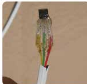
2. ábra: Higrotermikus monitoring rendszer kialakítása a hajdúnánási hőszigetelt családi ház dél-keleti homlokzati hőszigetelésében
