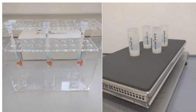
1. ábra – Ioncserélő gyantás kémiai elválasztás (bal kép), valamint a savas bepárlás (jobb kép) felszín alatti vizek stronciumizotóp-arányának méréséhez
