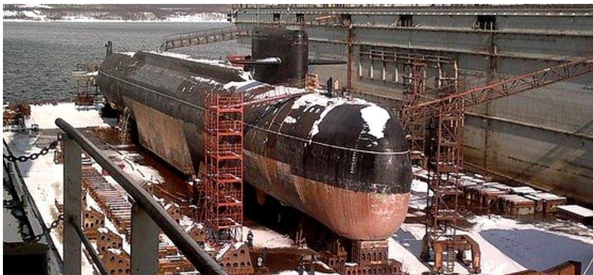
A BS-136 Orenburg speciális rendeltetésű tengeralattjáró az úszó szárazdokban. Jól látható, hogy a ballisztikus rakéták tárolására használt teret a hajótest alsó felének irányába hosszabbították meg, míg a hajótest felső részén megrövidítették.
