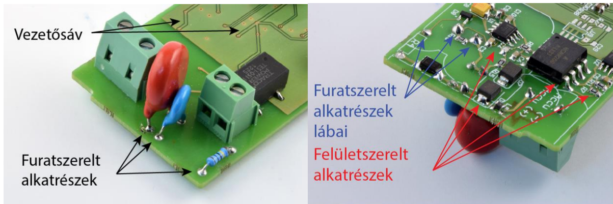
3. Ábra - Kétoldalú NYÁK, melyre mindenféleképpen rögzítettek alkatrészeket
