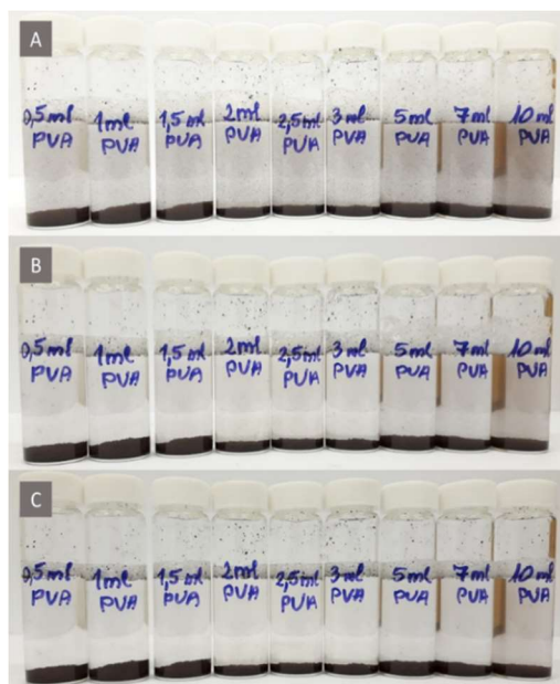
21. ábra: PVA polimerrel stabilizált diszperzió sorozat: A) összerázás után, B) 5perc után, C) 15 perc után
