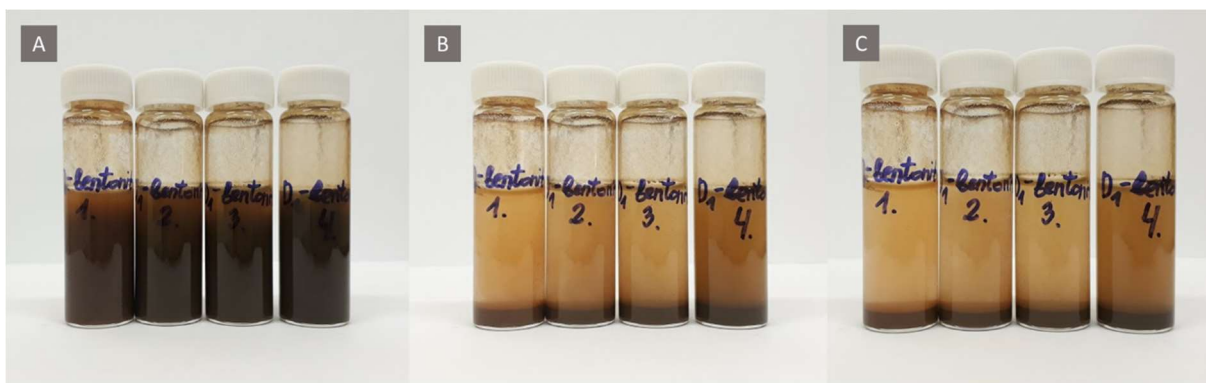
19. ábra: Bentonittal stabilizált diszperzió sorozat: A) összerázás után, B) 5perc után, C) 15 perc után
