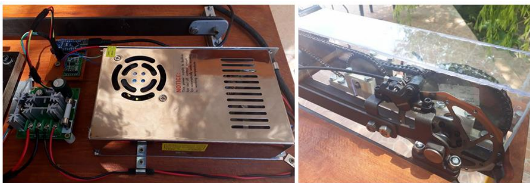
10. ábra - Az elektronikus alkatrészek és a védőburkolat
