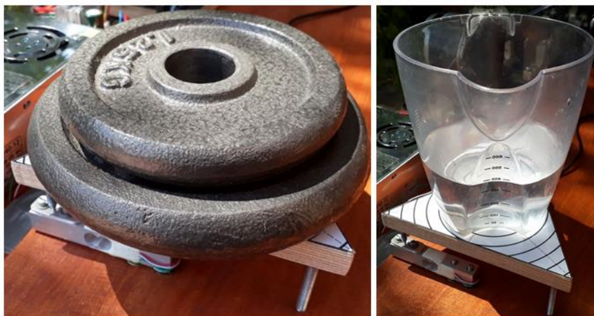
14. ábra - Az erőmérő cella kalibrációjához használt súlyok
