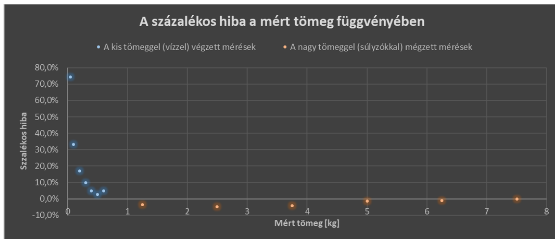
18. ábra - A mérőbélyeg kalibrációjának százalékos hibája
