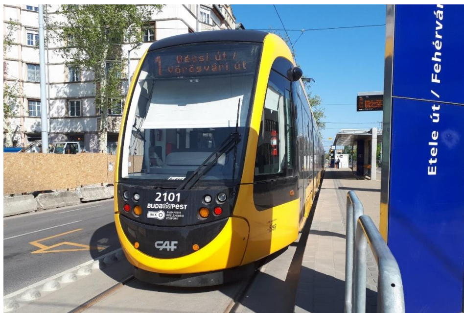
2. kép: 2101 pályaszámú CAF Urbos3, 9 modulból álló járműve (Etele út/Fehérvári úti megállóhely)
