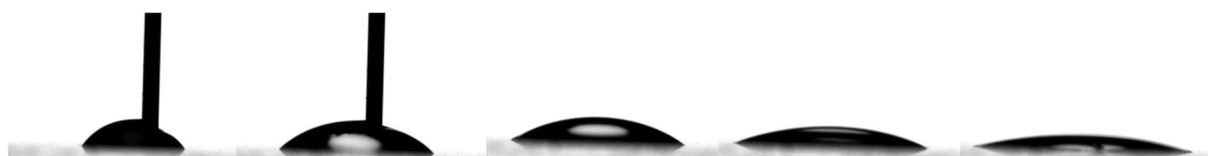
14. ábra: Vízcsepp kialakítása üveghordozóra felvitt, majd DCDMS 1%-os hexános oldatában 30 percig kezelt natív kitozánbevonat felszínén a cseppképzés 3., 5., 10., 20. és 40. másodpercében.
