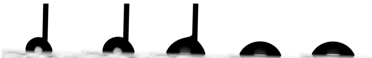
21. ábra: Vízcsepp kialakítása üveghordozóra felvitt, majd tiszta HMDS gőzterében 24 óráig kezelt kitozánbevonat felszínén a cseppképzés 3., 5., 10., 20. és 40. másodpercében.
