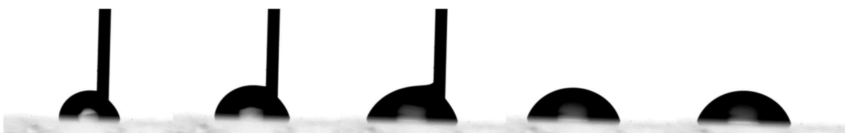
20. ábra: Vízcsepp kialakítása üveghordozóra felvitt, majd tiszta HMDS gőzterében 6 óráig kezelt kitozánbevonat felszínén a cseppképzés 3., 5., 10., 20. és 40. másodpercében.
