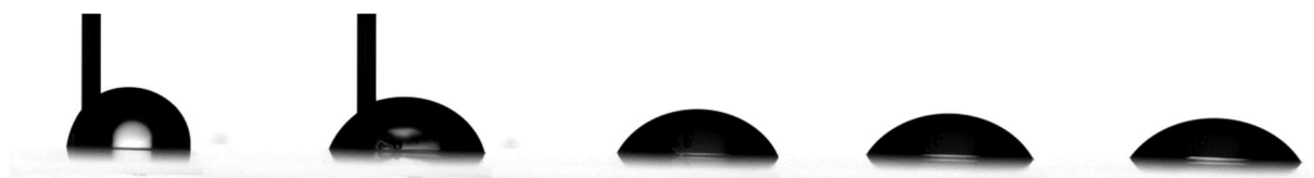
22. ábra: Vízcsepp kialakítása üveghordozóra felvitt, TPP-val keresztkapcsolt, majd DCDMS 1%-os hexános oldatában 30 percig kezelt kitozánbevonat felszínén a cseppképzés 3., 5., 10., 20. és 40. másodpercében.
