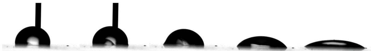
16. ábra: Vízcsepp kialakítása üveghordozóra felvitt, majd DCDMS 10%-os hexános oldatának gőzterében 30 percig kezelt kitozánbevonat felszínén a cseppképzés 3., 5., 10., 20. és 40. másodpercében.
