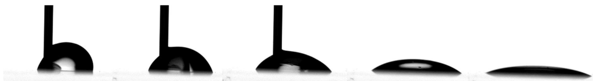
17. ábra: Vízcsepp kialakítása üveghordozóra felvitt, majd DCDMS 10%-os hexános oldatának gőzterében 60 percig kezelt kitozánbevonat felszínén a cseppképzés 3., 5., 10., 20. és 40. másodpercében.
