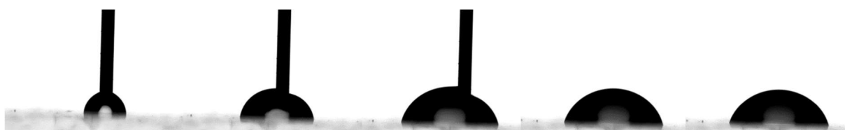
13. ábra: Vízcsepp kialakítása üveghordozón levő natív kitozánbevonat felszínén a cseppképzés 3., 5., 10., 20. és 40. másodpercében.
