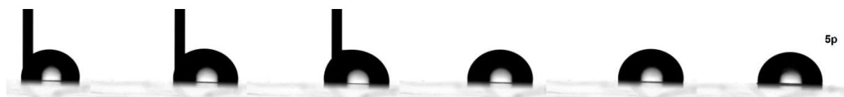
23. ábra: Vízcsepp kialakítása üveghordozóra felvitt, GDA-val keresztkapcsolt, majd DCDMS 1%-os hexános oldatában 30 percig kezelt kitozánbevonat felszínén a cseppképzés 3., 5., 10., 20. és 40. másodpercében, valamint az 5. percben.
