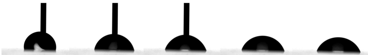
18. ábra: Vízcsepp kialakítása üveghordozóra felvitt, majd 30 percig hexán gőzterében tartott natív kitozánbevonat felszínén a cseppképzés 3., 5., 10., 20. és 40. másodpercében.
