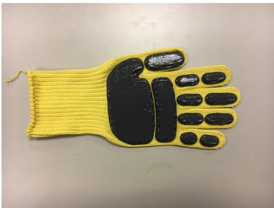
34 ábra: Egyrétegű kesztyű prototípus, 3D nyomtatással készült szilikon lapocskákkal (K3D2)(16. minta)
