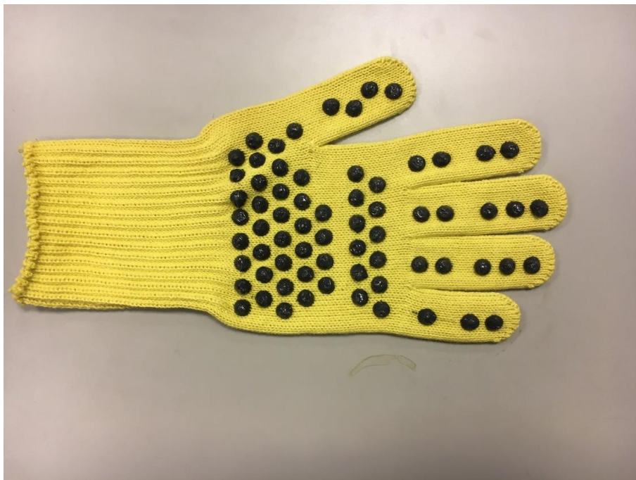
33 ábra: Egyrétegű kesztyű prototípus, 3D nyomtatással készült szilikon „bütykökkel” (K3D1), (15. minta)
