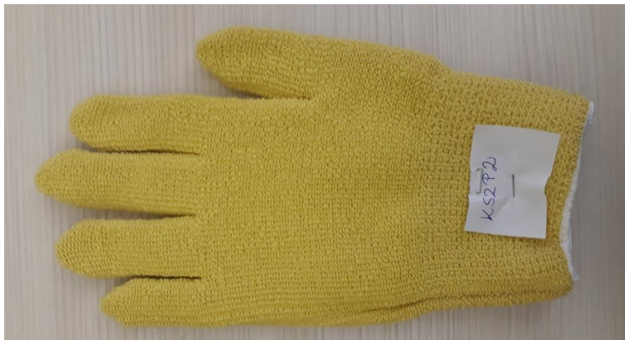
39 ábra: Kevlar plüsskötésű kesztyű prototípusa, kétrétegű zöld szilikonnal és pamutbéléssel (KSZ22) (24. minta)
