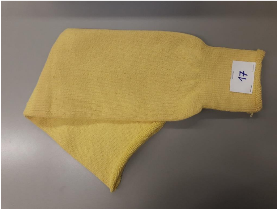
35. ábra: Egyrétegű kevlár csökelme prototípusa láb védelmére (17. minta)
