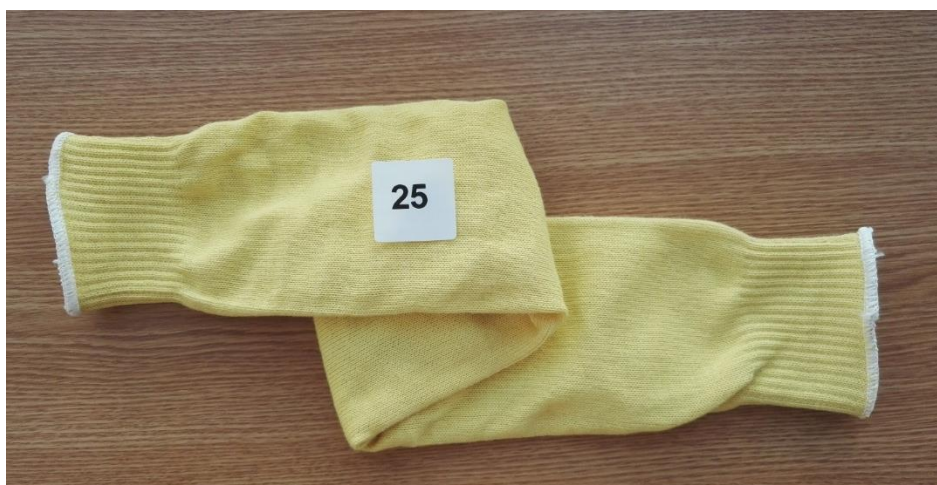
40 ábra: Kevlar lábvédő pamutbéléssel (25. minta)
