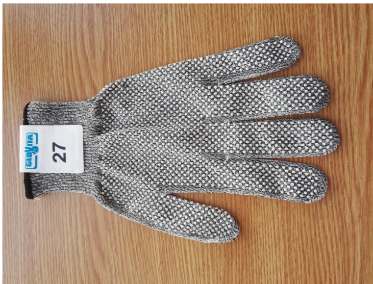
42. ábra: PA/PES/üvegszál fitalátmentes kesztyű, pamutbéléssel (27. minta)
