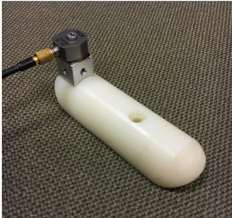
11. ábra: A vizsgálandó kesztyűn belül, a kísérleti személy tenyerébe helyezendő illesztődarab a kézre ható rezgés mérésére szolgáló rezgésérzékelő elhelyezéséhez
