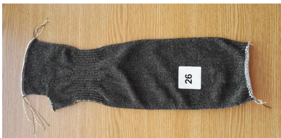
41 ábra: PA/PES/üvegszál lábvédő pamutbéléssel (26. minta)
