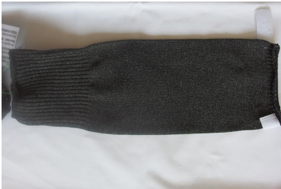
36. ábra Kötött karvédő, 40% poliamid, 40% poliészter, 20% üvegszál felhasználásával (18. minta)
