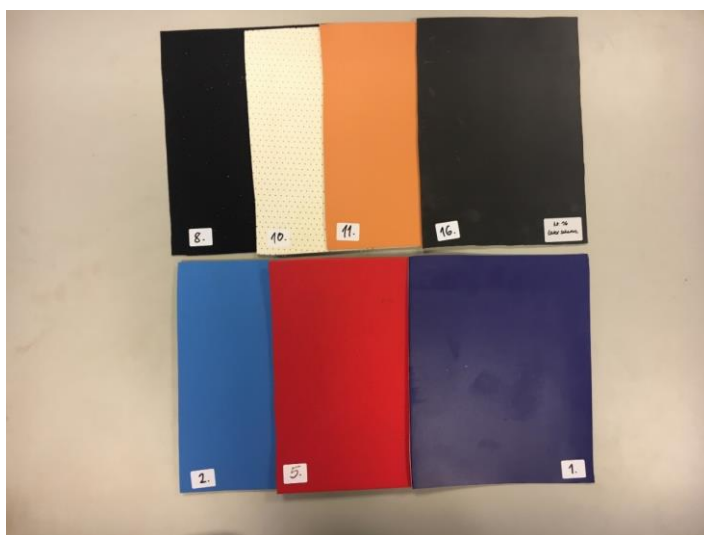
17. ábra: Betét készítés szempontjából vizsgált üreges textil és szivacs anyagminták
